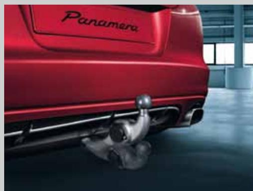
**Elektrisch ausklappbare Anhängезugvorrichtung**
